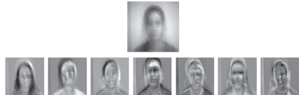
Figura 4. Exemplo de face média (acima) e Eigenfaces mais importantes para o conjunto de treino.
