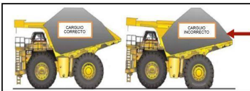
Figura 32 Método de carguío a los equipos de acarreo
