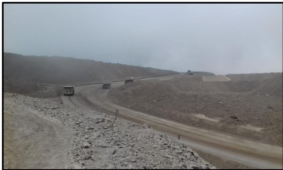
Figura 9 Proceso de Acarreo - Camión KOM HD 1500-7
