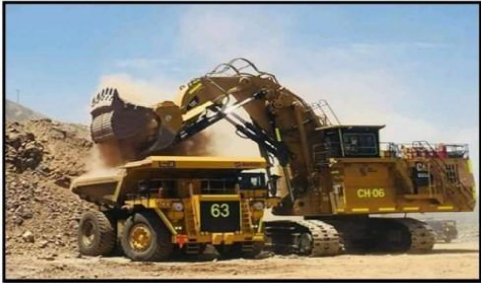
Figura 8 Proceso de Carguío - Pala CAT 6050
