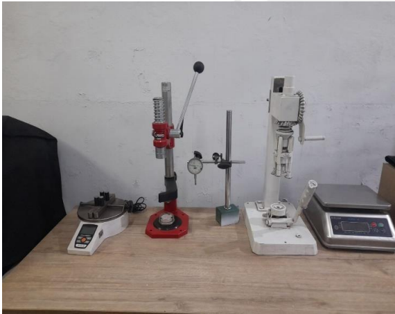
Equipos de Torque, cierre de tapas tipo corona, reloj comparador, cierre de tapas metálicas y balanza.
