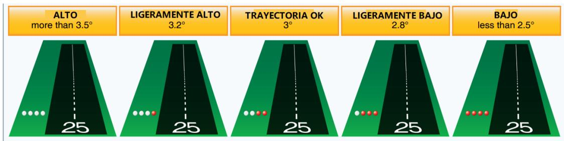
Indicador de la trayectoria de aproximación de precisión para una pendiente de planeo típica de 3°.
