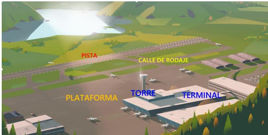
Figura 2.3: Componentes de un aeropuerto (Fuente: OACI)
