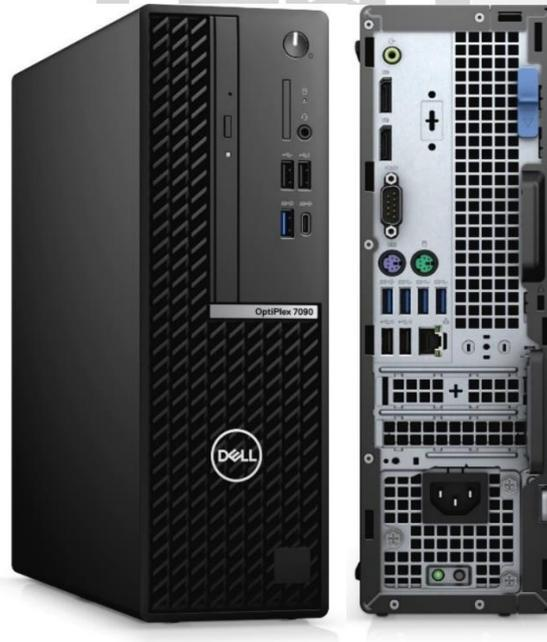
Figura 4.44: Vistas de PC DELL Optiplex Serie 7000. (Fuente: Dell Computer)
