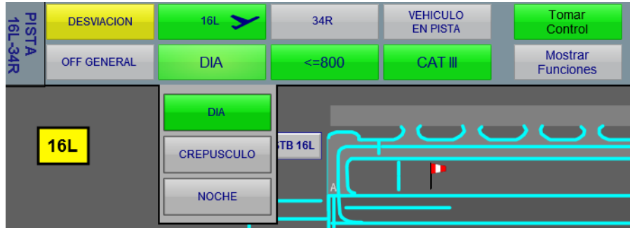
Figura 4.35: Grupo de Iluminación de Ambiente del Sistema SCADA. (Fuente: E. Propia)
