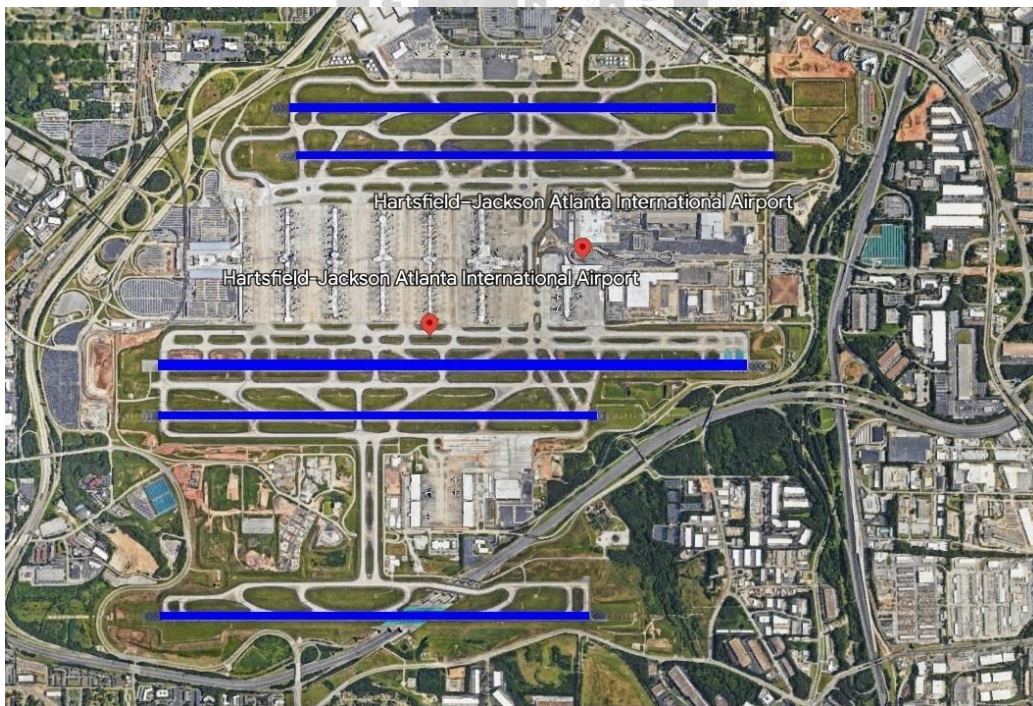
Figura 2.4: Configuración de aeropuerto Atlanta en Georgia USA, con 5 pistas con cabeceras P1 (8L-26R), P2 (8R-26L), P3 (9L-27R), P4 (9R-27L) y P5 (10-28), es el aeropuerto con mayor tránsito de vuelos y pasajeros llegando a 110 Millones antes de pandemia. (Fuente IATA)
