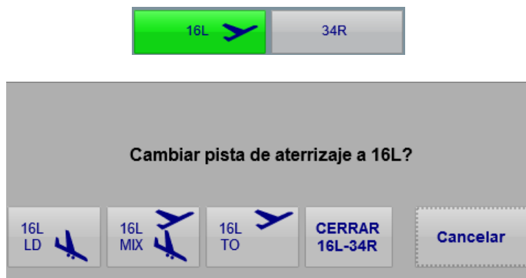
Figura 4.38: Selección de Dirección de Operaciones en Pista del Sistema SCADA. (Fuente: E. Propia)
