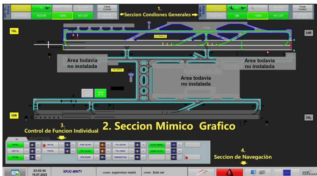
Figura 4.33: Ventana Vista General del Aeropuerto del Sistema SCADA AIJCH. (Fuente: E. Propia)
