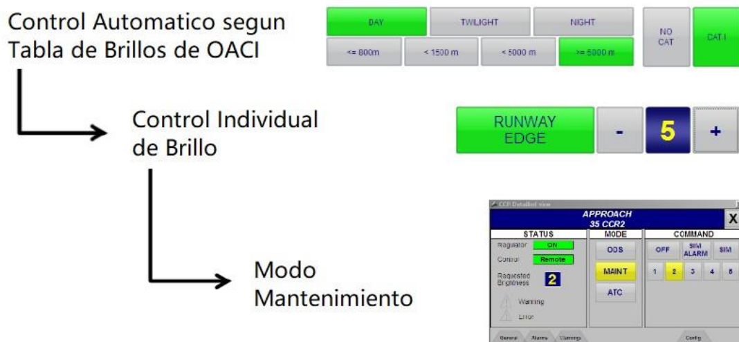
Figura 4.31: Niveles de Control para enviar comandos a los Equipos AGL. (Fuente: E. Propia)
