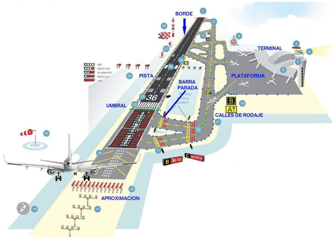
Figura 2.5: Partes de una Pista de Vuelo (Fuente: AERTEC Solutions)
