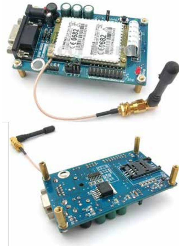
Figura 3. Módulo de comunicaciones GSM SIEMENS TC35i.
