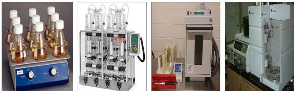
**Figura N° 27:** Diferentes métodos de extracción se muestran de izquierda a derecha: Extracción en frío, extracción con solvente, extracción de fluidos supercríticos (SFE), extracción asistida por microondas (MAE).
