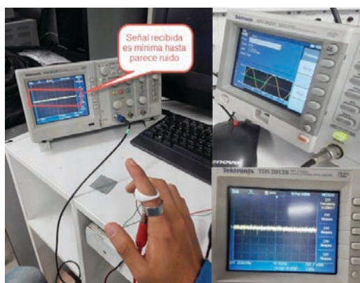
Figura 6: Prueba de limitador de potencia.
