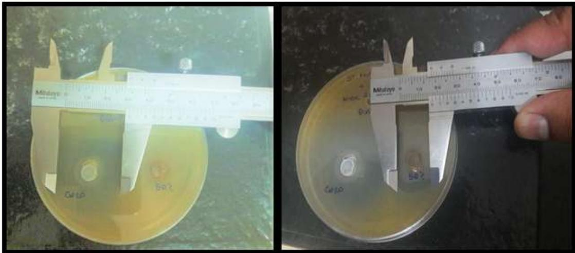
**Figura N°28:** Proceder a medir los diámetros de los halos de inhibición empleando el vernier.
