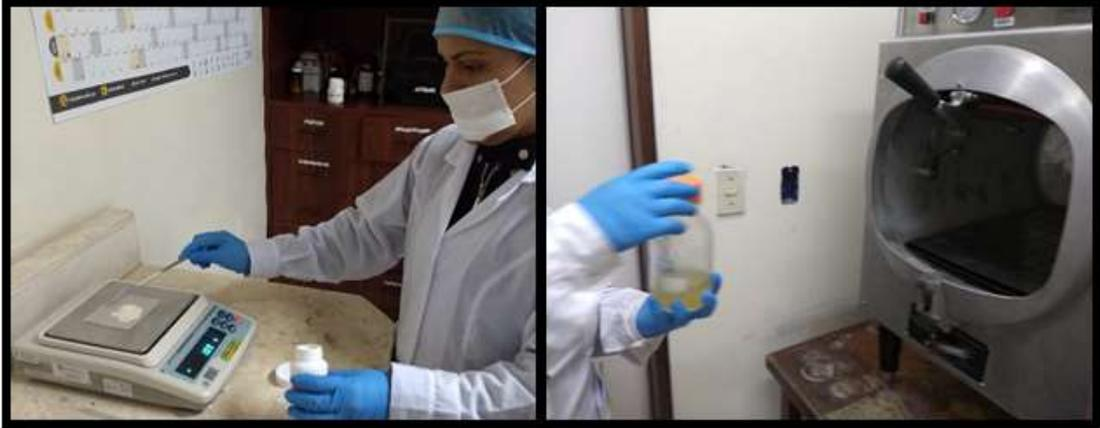
**Figura N°18:** 3,0 g de caldo Tioglicolato por cada 100 ml de agua destilada, calentar y esterilización en la autoclave a 121°C y 15 lb de presión por un periodo de 15 minutos.
