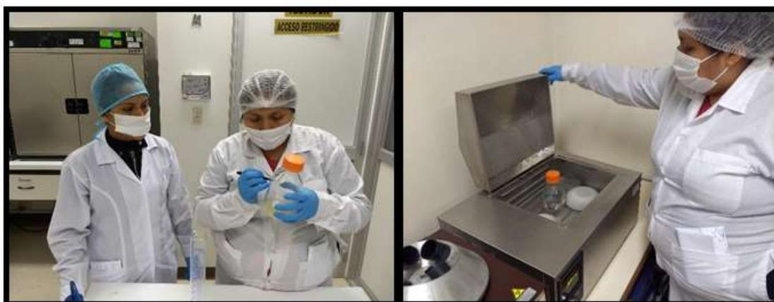
**Figura N°20:** Se procedió con la homogenización en baño María hasta lograr la disolución completa.
