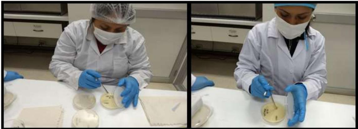
**Figura N°25:** Se hicieron excavaciones en número de tres por cada placa de 8mm de diámetro y 8 mm de profundidad.
