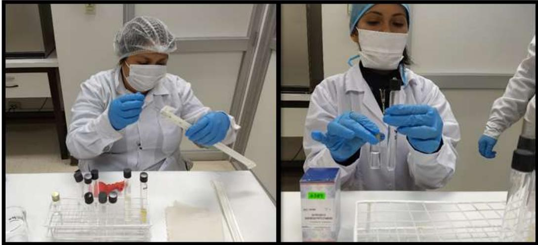
**Figura N°24:** A partir de cultivos de colonias se realizó una dilución con solución salina fisiológica estéril hasta alcanzar la turbidez equivalente al tubo N° 0,5 del Nefelómetro de Mac Farland ( $1.5 \times 10^8$  UFC/mL).
