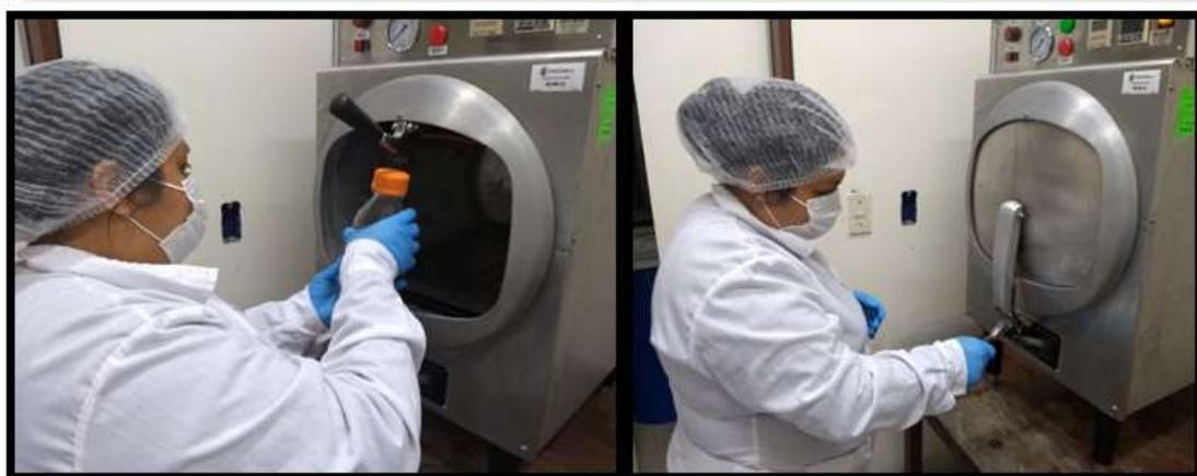
**Figura N°21:** Se realizó la esterilización en la autoclave del medio de cultivo a 121°C y 15 lb de presión por un periodo de 15 minutos.
