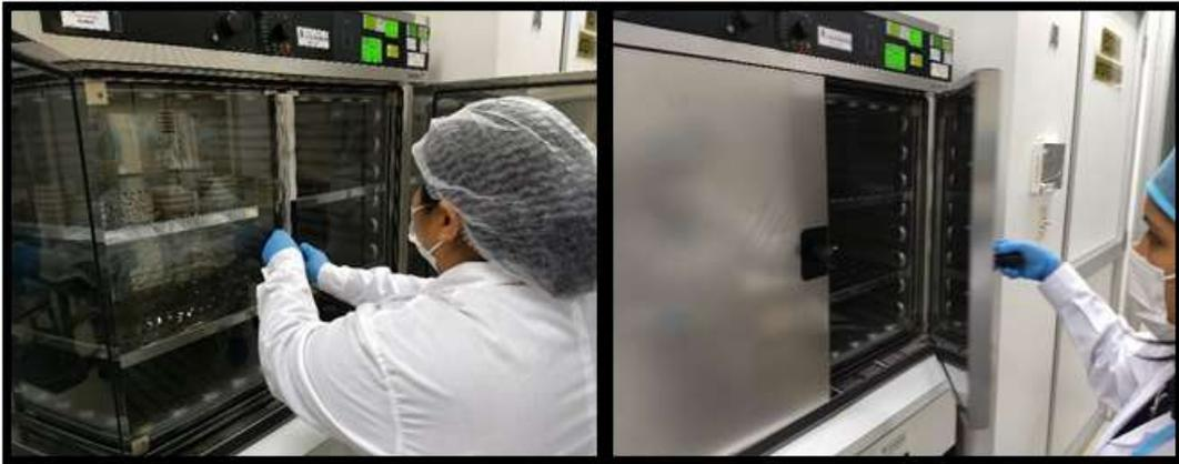
**Figura N°27:** Se rotuló cada una de las placas y luego a incubar las placas a 37°C por un periodo de 24 horas.
