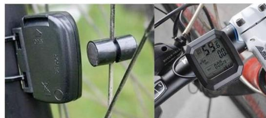
Figura 2: Odómetro electrónico de bicicleta.
