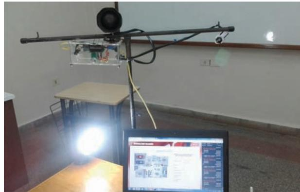
Figura 8. Prueba de perturbación de sensor de detección de llamas por luz fluorescente.
