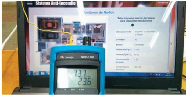
Figura 11. Comprobación de precisión del sensor de temperatura en comparación al termo higrómetro.
