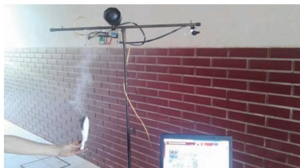
Figura 10. Prueba de detección de humo para establecer rango de lectura de sensor de detección de llamas.
