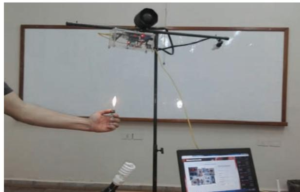
Figura 9. Prueba de detección de intensidad de llamas para establecer rango de lectura de sensor de detección de llamas.
