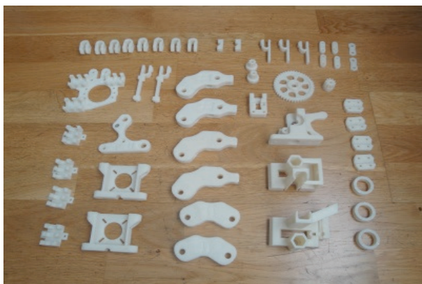
Figura 5. Uniones de la estructura para la plataforma DIAR 1.0.
