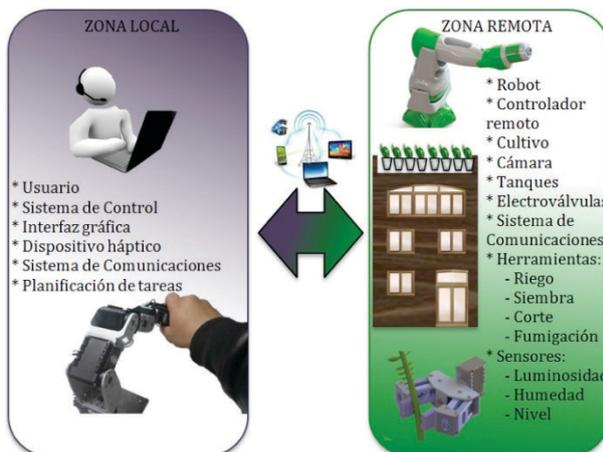
Figura 8: Diagrama general y resumido de la arquitectura del sistema.
