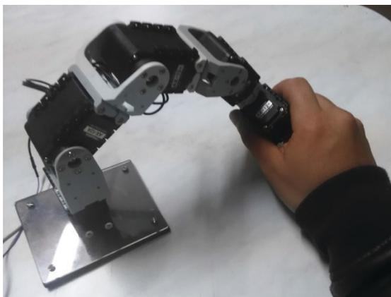
Figura 12: Robot maestro implementado para la teleoperación del robot.
