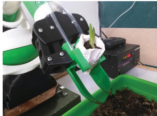
Figura 19: Robot esclavo haciendo tareas agrícolas por medio de un efector multifuncional para mover tierra, agarrar y regar.
