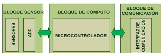
Figura 1: Arquitectura de hardware genérica de un nodo en una red de sensores.
