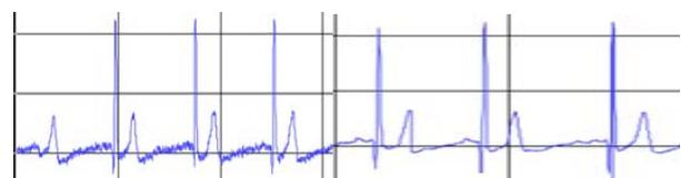
Figura 25: Señal ECG sin filtrar (izquierda) y filtrada (derecha) con el microcontrolador.
