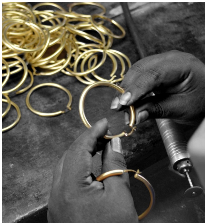
Figura 6. Proceso de retoque y ajuste de accesorio (Bangles Ensamble)
