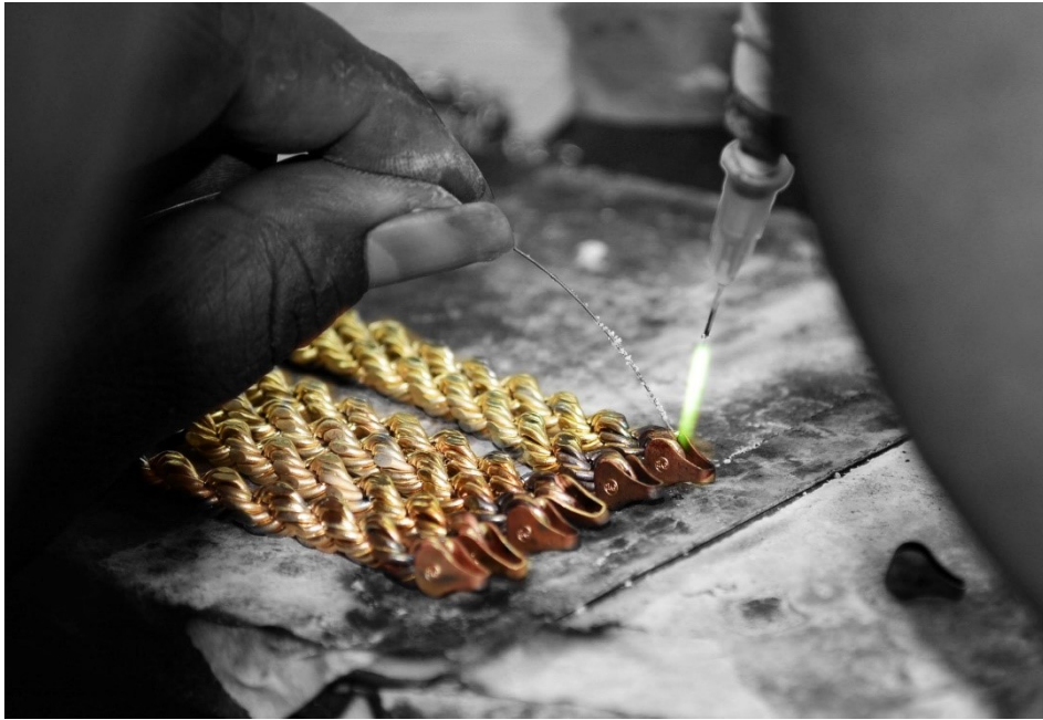
Figura 4. Soldado de la pinzetas a la cadena (Sujetador de Broches)
