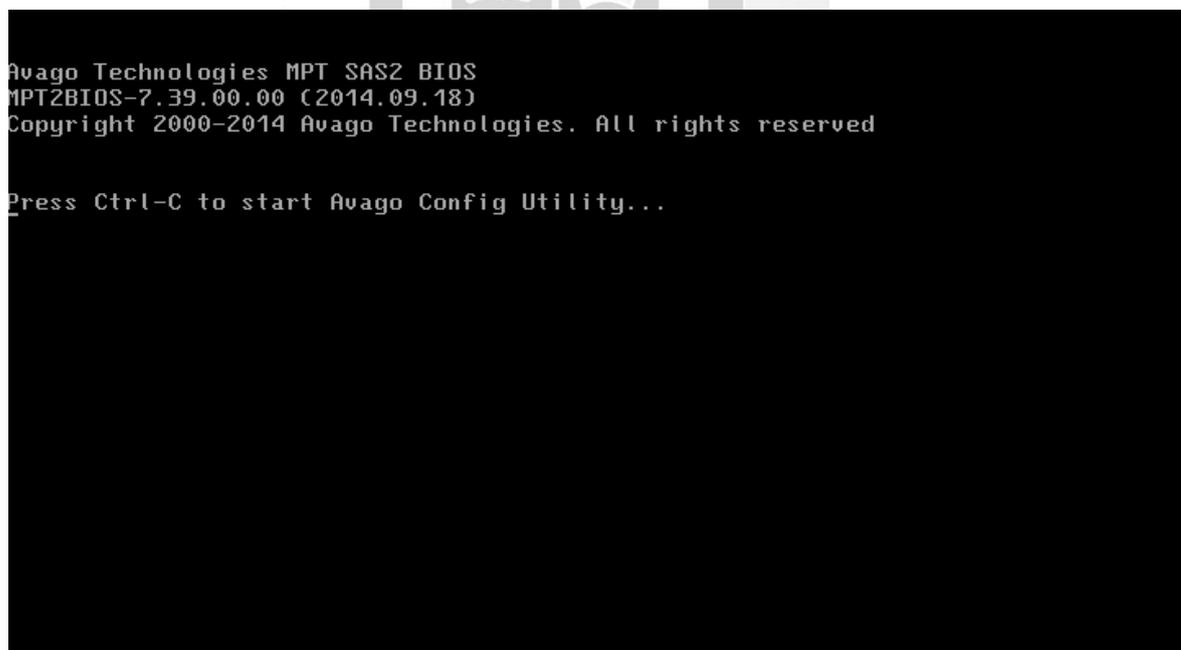
*Figura 26: Comando para la configuración del RAID para la instalación del CNA*
