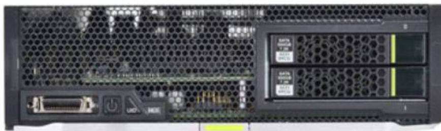
Figura 9: Imagen de un blade CH121 v3 de mediano tamaño
