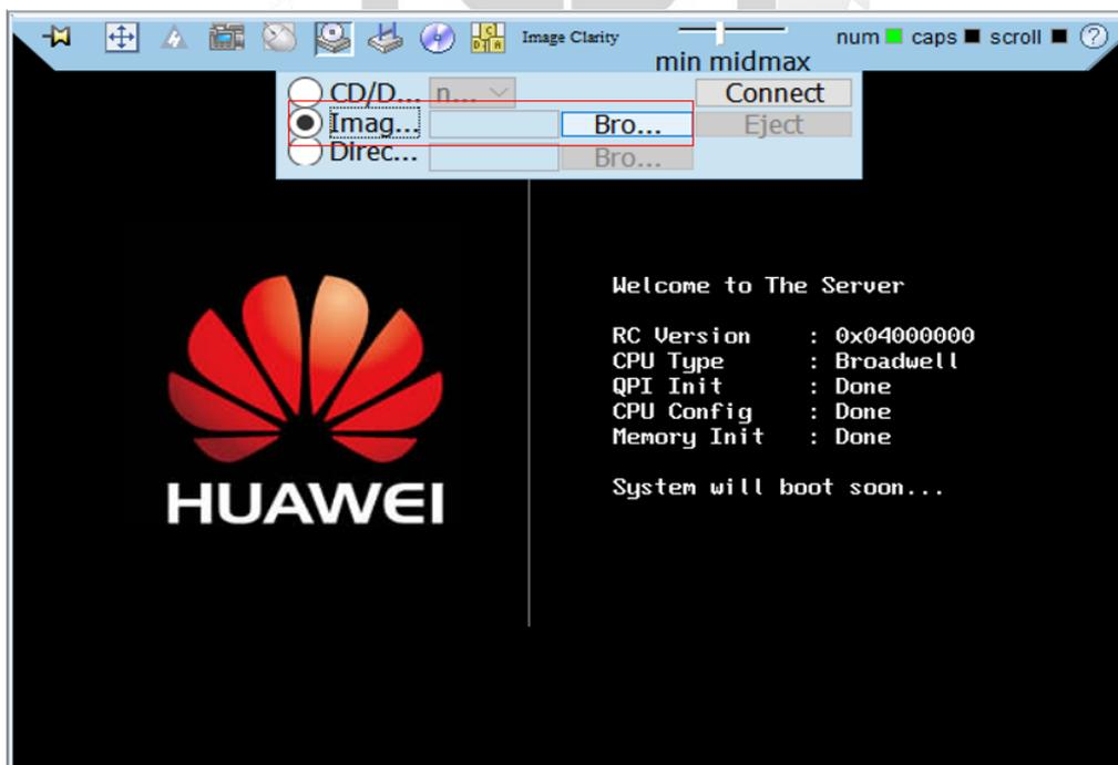
Figura 97: Visualización de la opción para adjuntar un archivo .ISO para la instalación del VRM
