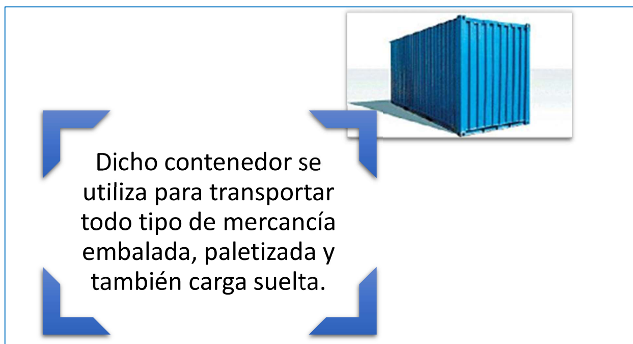
Figura 6. Tipo de Contenedor ISO Todo propósito DRY VAN/ GENERAL de 20 pies. Reimpreso con permiso. Elaboración Propia de la autora.
