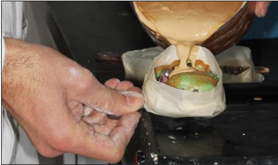
Figura 30. Vaciado en molde de yeso
