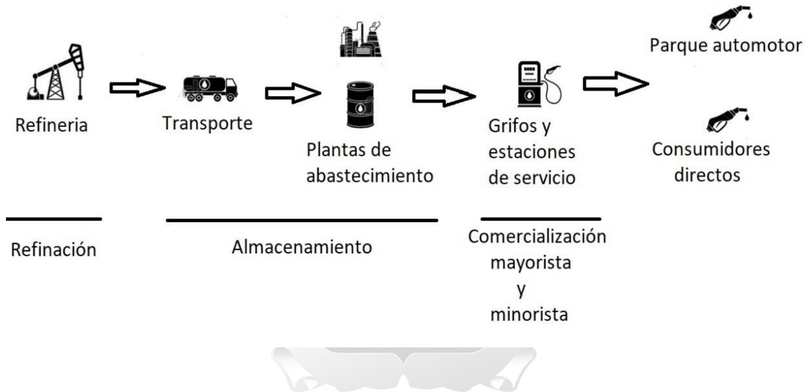
Figura 1. Flujograma procesal de la carga, transporte, descarga y comercialización.
