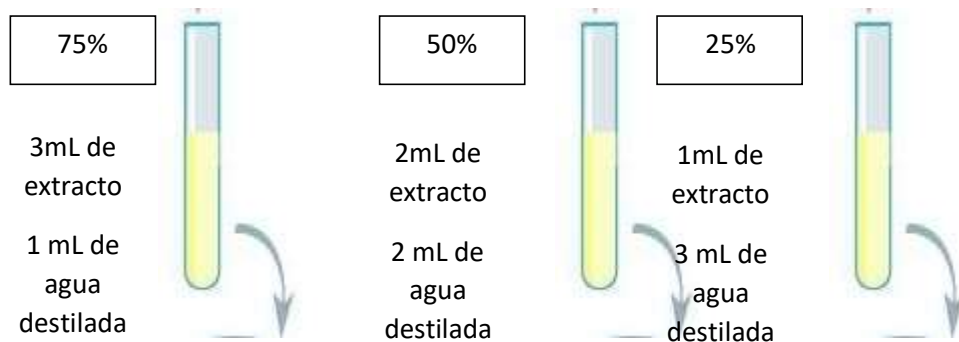
Figura 13 Preparación de concentraciones con el extracto etanólico de las hojas de Cistus ladanifer (Jara)
