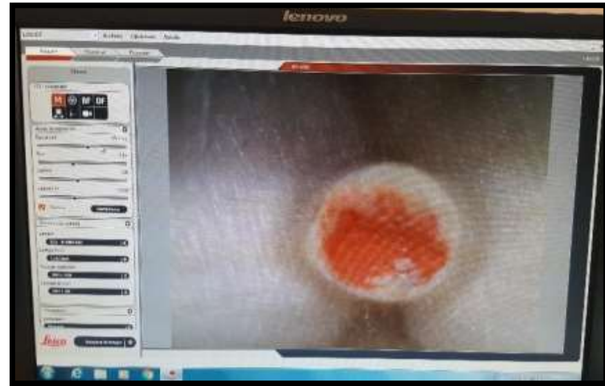
Fig N°18: Las muestras fueron llevadas al estereomicroscopio Leica S9APO a 40 X de máxima magnificación, todas la imágenes fueron grabados en un software LAS EZ versión 4.2 y cámara LEICA EC3, con una exposición de luz promedio m de 157.1 ms.
