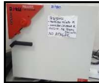
Fig N°13: Incubadora donde se coloca las muestras a 37,5°C con 100% de humedad por 7 días.
