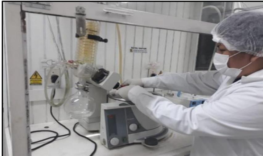
*Figura 9. Destilación al vacío de la maceración*
