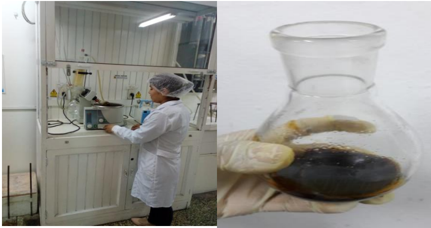
Figura N° 25: Fotografía de manipulación del rotavapor y la obtención del extracto sin solvente.
