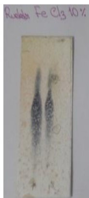
Figura 14. Cromatogramas de los extractos de tara (T) y molle (M) revelado con cloruro férrico.
