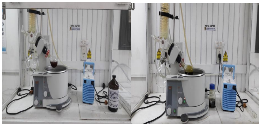
Figura N° 24: Fotografía del uso de la Rotavapor muestra de las vainas de Caesalpinia spinosa (Molina) Kuntze (Tara) y de las hojas del Shinus Molle L. (Molle)
