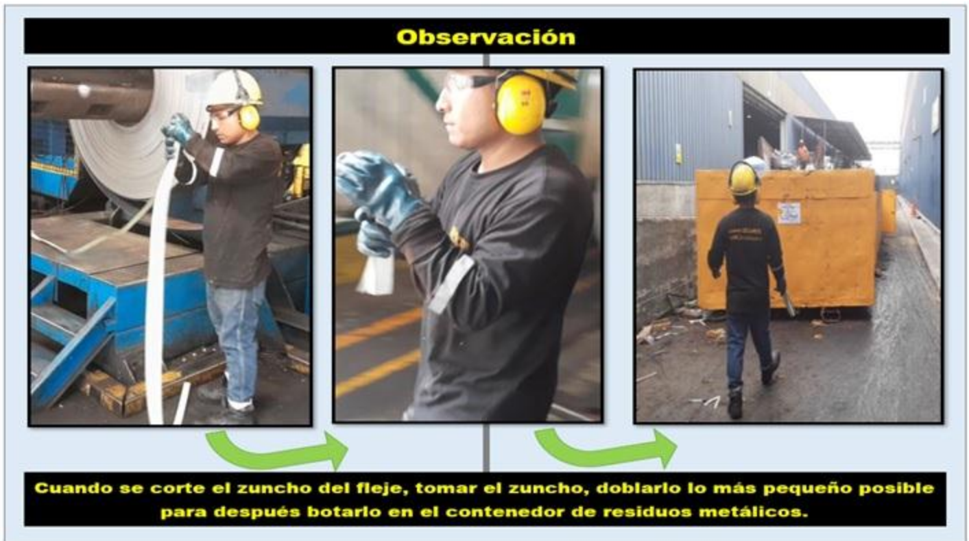
figura 28:instructivo de zona de empalme 10
