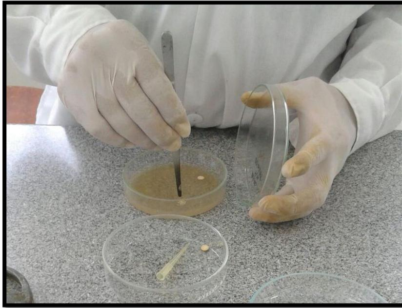
Ilustración 6. Colocando los discos de control positivo (Fluconazol 25ug) en placa ya inoculada.
