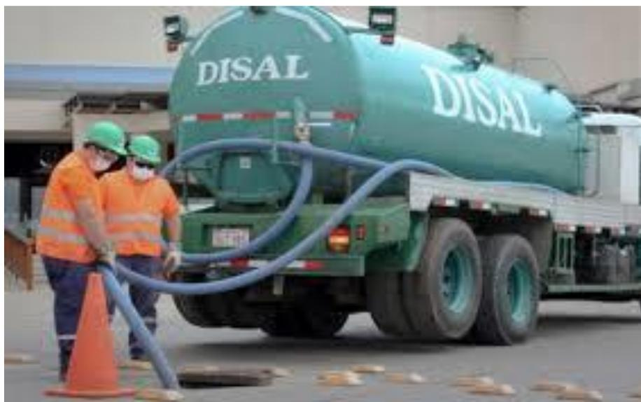
*Ilustración 15 Operadores y cisterna de succión de residuos líquidos. Fuente: Internet.*
