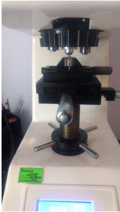
Figura 11. Durómetro Micro Vickers con los cilindros a prueba.
