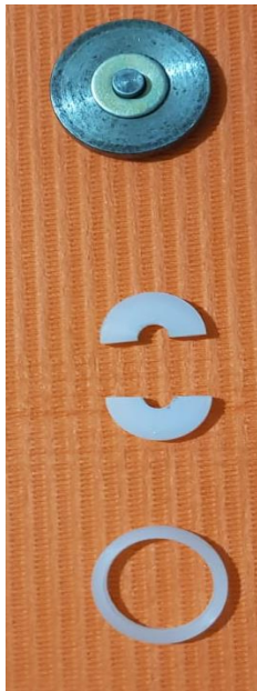
Figura 02. Preformadores de Nylon y Metal para la elaboración de cilindros de resina.
