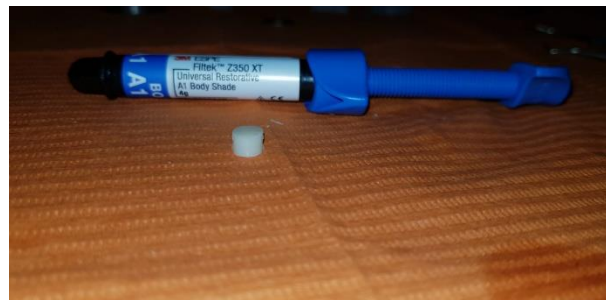
Figura 09. Elaboración final del cilindro de 4 mm.de la Resina Filtek Z350XT 3M
