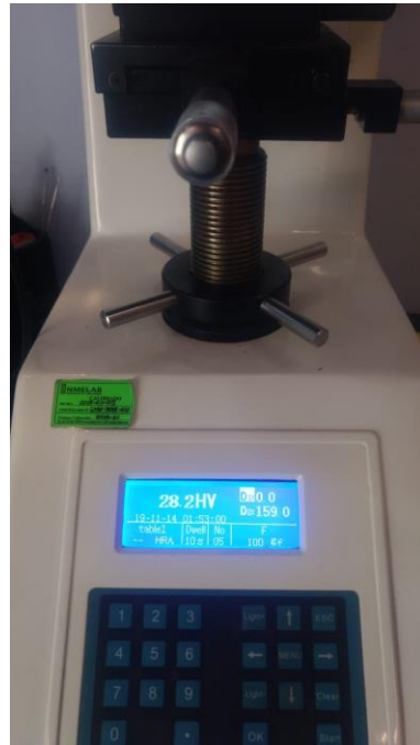
Figura 11. Durómetro Micro Vickers con los cilindros a prueba.
