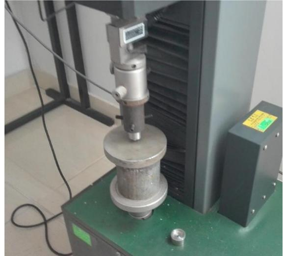
**Figura 09.** Evaluación física de la fuerza compresiva de los cilindros de resina.
