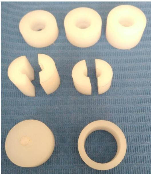
**Figura 02.** Preformadores de Nylon para la elaboración de cilindros de resina y toques de Nylon con las 3 medidas de distancia de fotoactivación.
