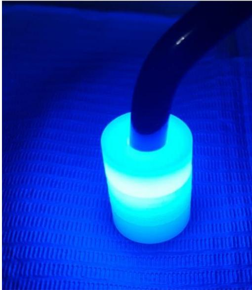
**Figura 04.** Fotoactivación de la resina con la lámpara de luz led por 40 segundos a 2 mm de distancia, de igual manera con el tope de 4 y 6 mm.
