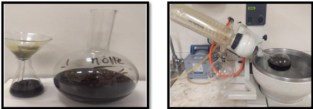
Figura 26. Filtrado del macerado de Schinus molle L. (Molle), concentración de la muestra en Rotavapor y estufa.
