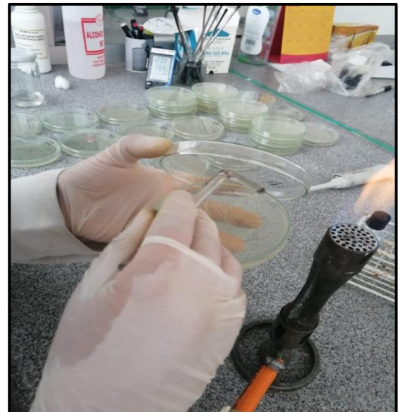
Realizar la siembra con la espátula de Drigalsky en la superficie del agar.
