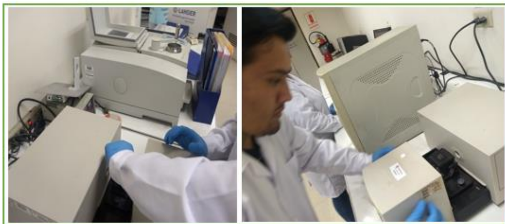
Lectura del sobrenadante en el UV-VIS
