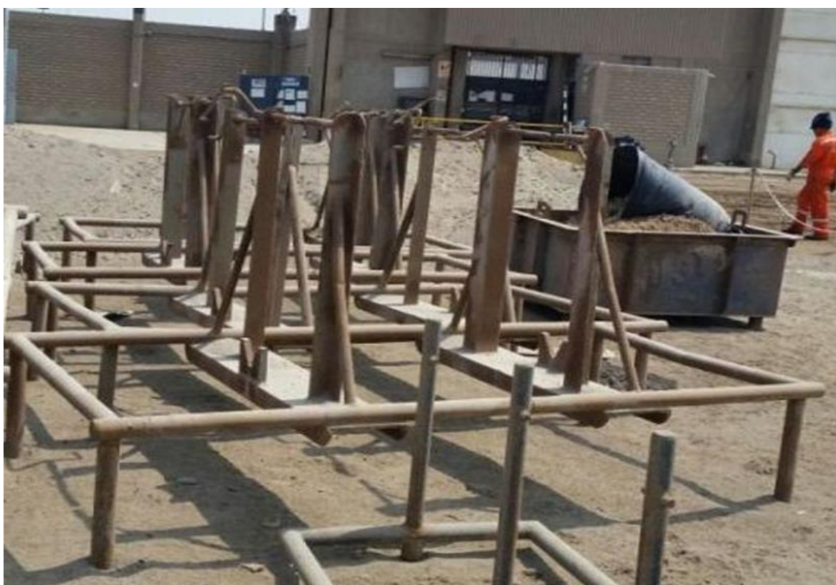
Fig. N° 38: Vista Frontal del Prototipo de la Base para Arenado y Pintado de Planchas de Acero del Proceso propuesto.
