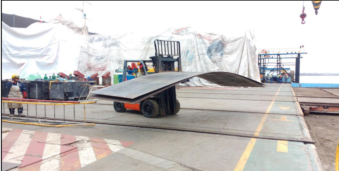
Foto N°1: Transporte de Planchas a zona de Arenado
