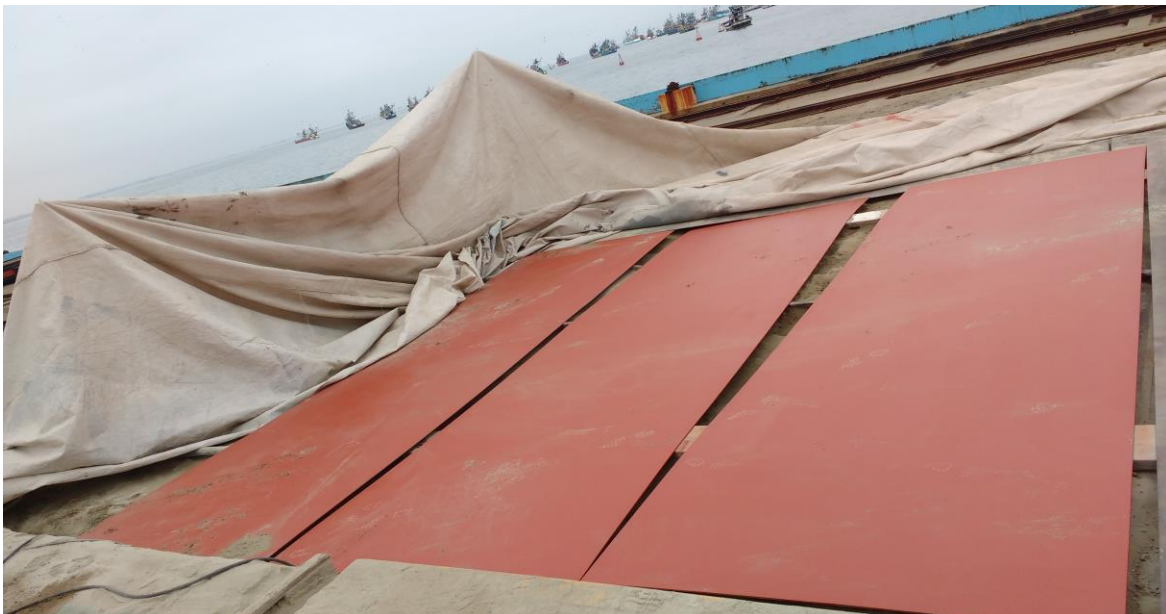
Foto N°6: Planchas arenadas segunda Cara
