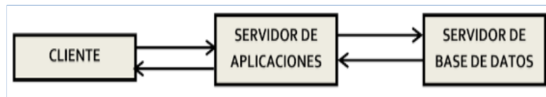
Figura 2.4: Estructura de una arquitectura Cliente-Servidor de tres capas. (García, A. 2015)
