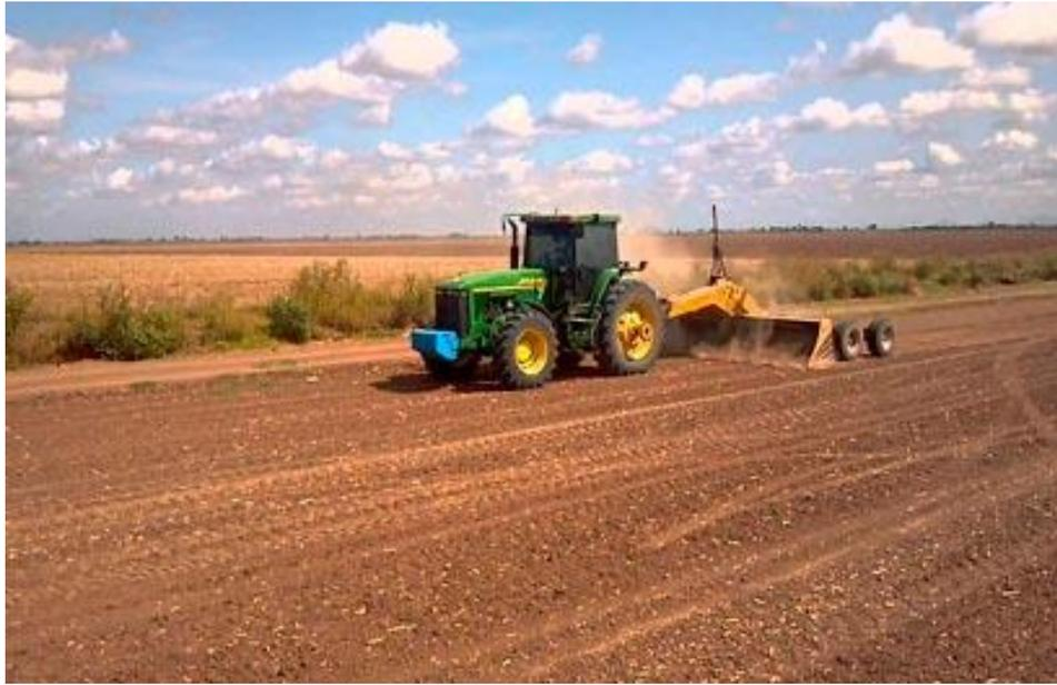
*Figura.\_ 28 Nivelación: Preparación de Suelo*
