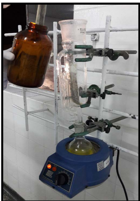
Fotografía 7: Introducir los cartuchos en el tubo de extracción y echar en el balón el éter de petróleo usado en la maceración. Encender la coccinilla a una temperatura de 40° entre 1 o 2 horas.
