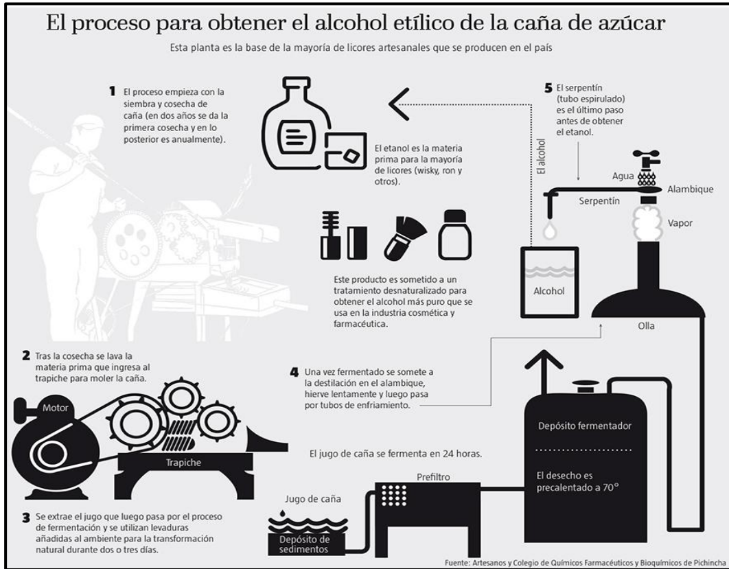
Figura 1: Proceso para la obtención de alcohol etílico de la caña de azúcar Fuente: Artesanos y colegio de Químicos Farmacéuticos y Bioquímicos de Pichincha (26)
