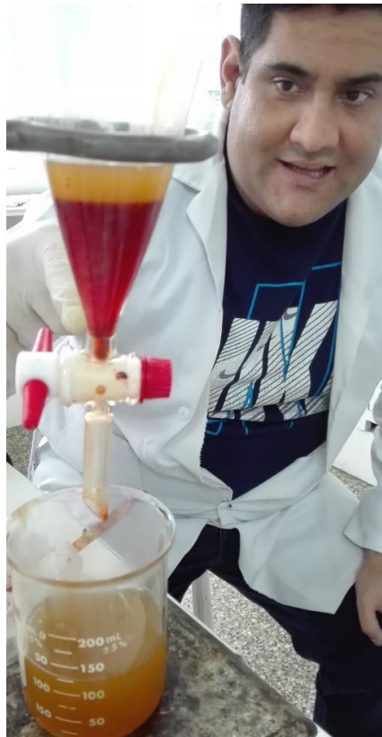
Extracción por partición del extracto etanólico de la corteza de Ficus pertusa . Fuente: Elaboración propia
