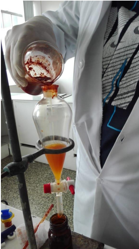
Extracción por partición del extracto etanólico de la corteza de Ficus pertusa . Fuente: Elaboración propia
