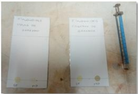
Fotografía 14: Prueba de cromatografía en capa fina del extracto hidroalcohólico de las hojas del arrayán y del extracto acuoso de la cáscara del fruto granada – flavonoides
