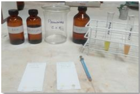
Fotografía 14: Prueba de cromatografía en capa fina del extracto hidroalcohólico de las hojas del arrayán y del extracto acuoso de la cáscara del fruto granada – flavonoides
