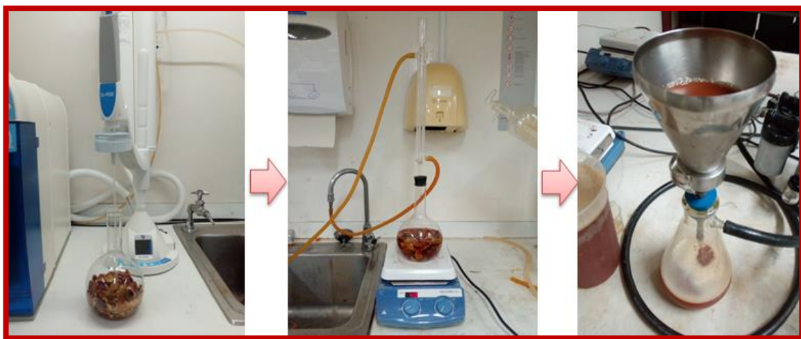
Fotografía 8: Obtención del extracto acuoso de la cáscara del fruto granada mediante la técnica de extracción por reflujo (24 horas) y filtración al vacío.
