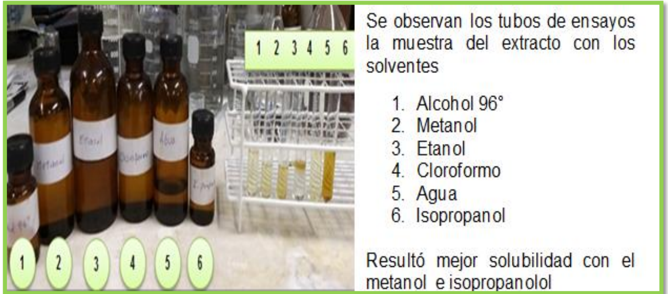
Fotografía 9: Prueba de solubilidad del extracto hidroalcohólico de las hojas de Luma chequen (Molina) A. Gray (arrayán)
