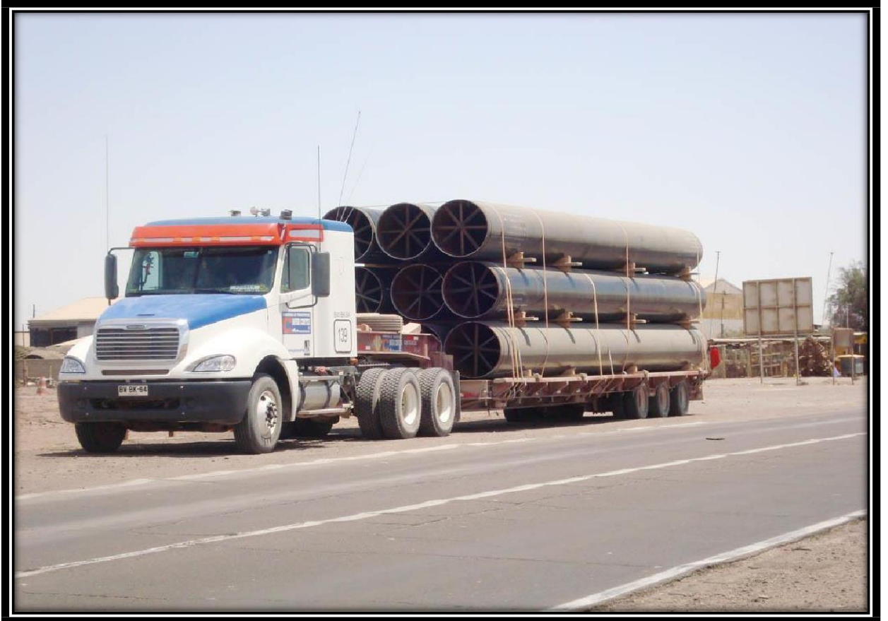
Imagen 26. Fuente: Área Operaciones DAGAL S.A.C. (Fijación de la carga)
