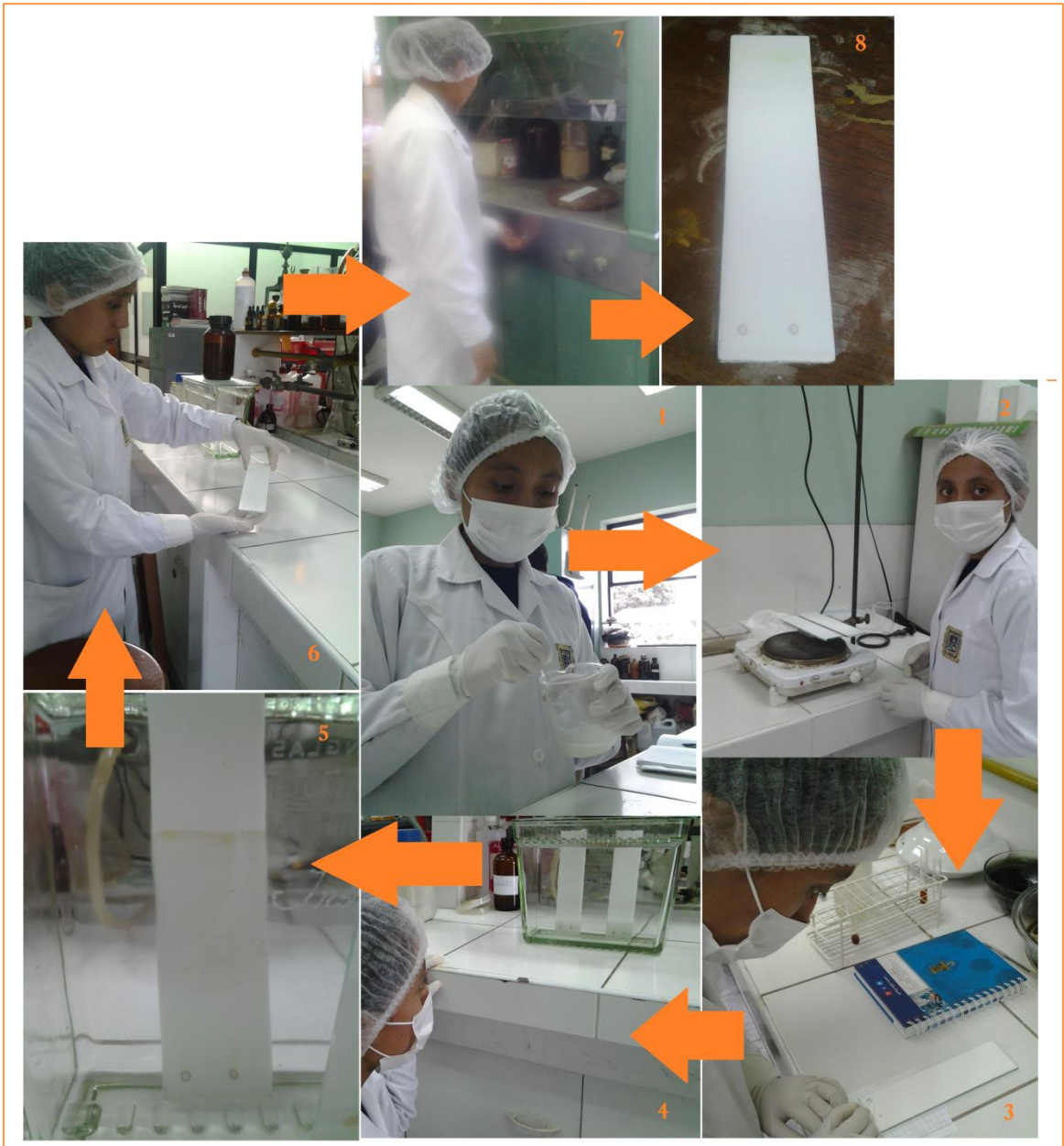
Figura 33. Cromatografía preparativa en capa fina
