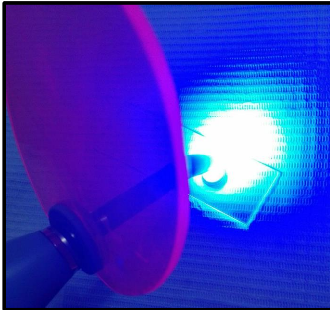
Imagen N° 04: Fotocurado con Lámpara de luz LED con una intensidad de 800 \text{ W/cm}^2
