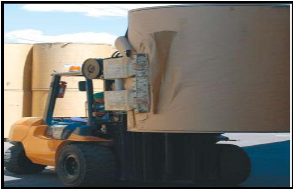
Figura 40: Bobina dañada por parte del proveedor:
