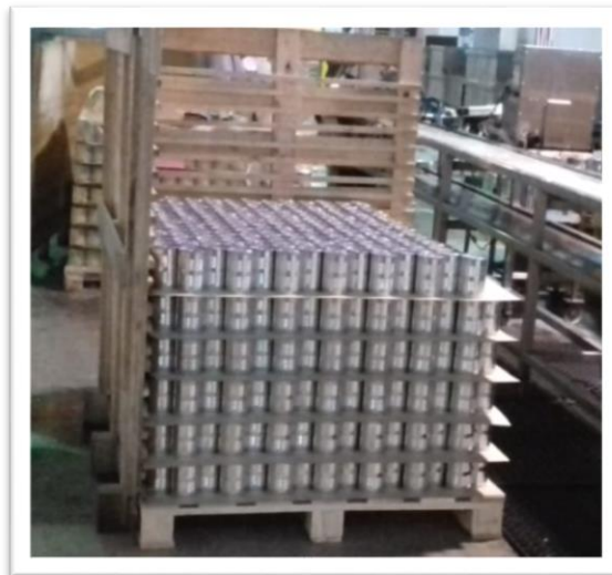
Imagen 14: Correcto Armado con Implementación de Escuadras
