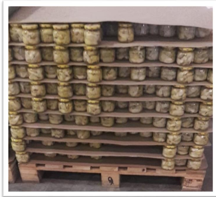
Imagen 12: Incorrecto Armado de Pallets
