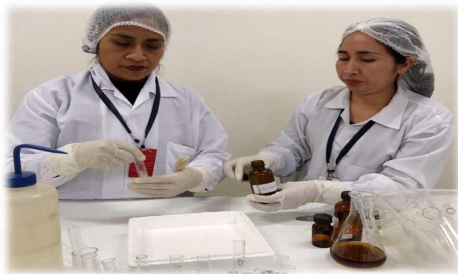
Figura 20: Prueba de solubilidad (Alcohol 96°C, isopropanol, agua, cloroformo y metanol).
