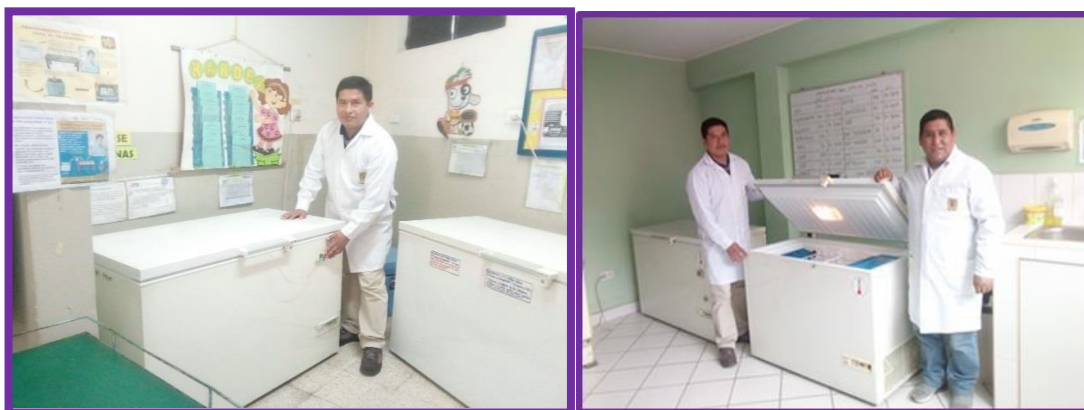
Fig. 5: Equipos frigoríficos de pared de hielo (Ice-Line refrigerators)
