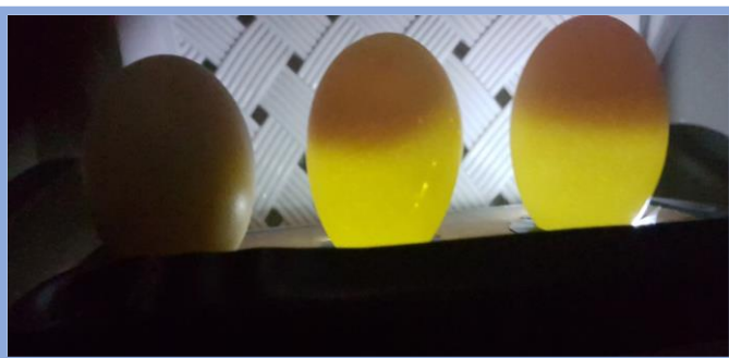
FIGURA 11 Ovoscopio artesanal para el HET CAM
