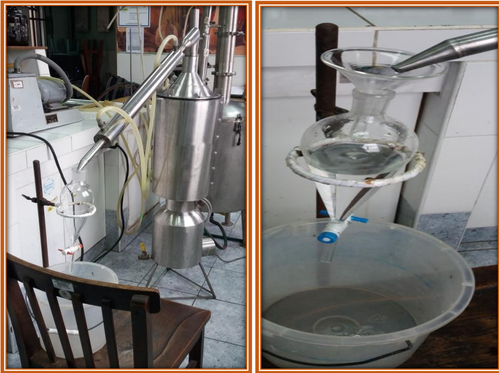
Figura N°10: Armar el sistema de destilación que consta de una caldera de 8 litros de capacidad, una tolva, un refrigerante y las mangueras de conexión
