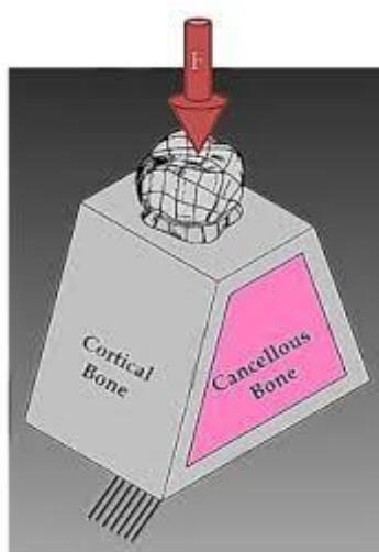
FIGURA 13. Simulación de fuerzas oclusales sobre restauraciones de cerámica (19)
