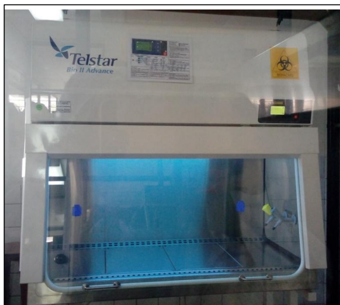
Fig. N°30: Cabina de flujo laminar TELSTAR
