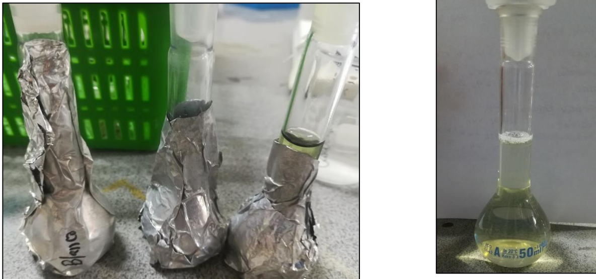
Fig.N°38: Fiolas cubiertas con papel platino para asegurar que la luz no interfiera con la reacción
