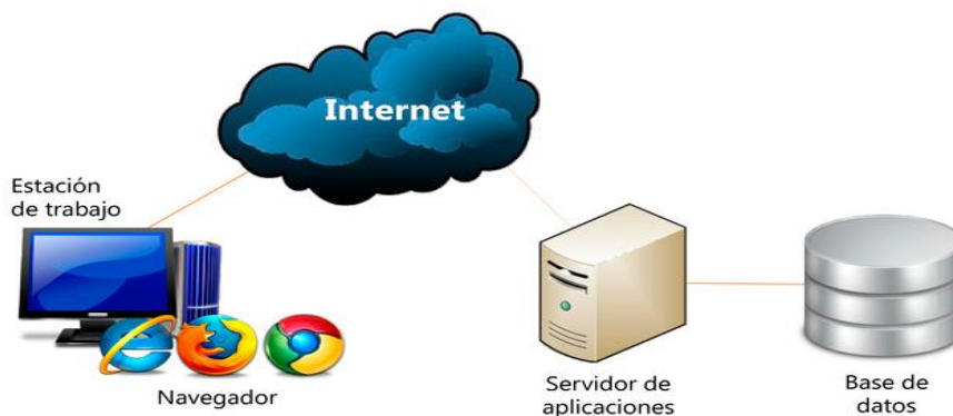
Figura 2.1: Estructura de una aplicación web en tres capas. Según Moreira (2014)
